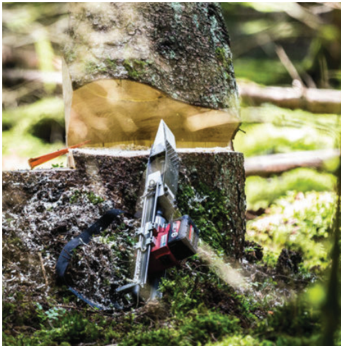
Raus aus dem Gefahrenbereich: Besonders wenn die Gefahr hoch ist, dass Äste abbrechen und herabstürzen, sind Funkkeile ein Segen – denn bedient werden sie per Knopfdruck aus sicherer Entfernung. Mit dem Seil lässt sich das Hebelgesetz nutzen: Doppelte Anschlaghöhe des Seils, bedeutet halber Zugkraftbedarf. Im Bild rechts ist das Seil in ca. 6 m Höhe. Darum sollte auch immer die nötige Ausrüstung am Start sein.
