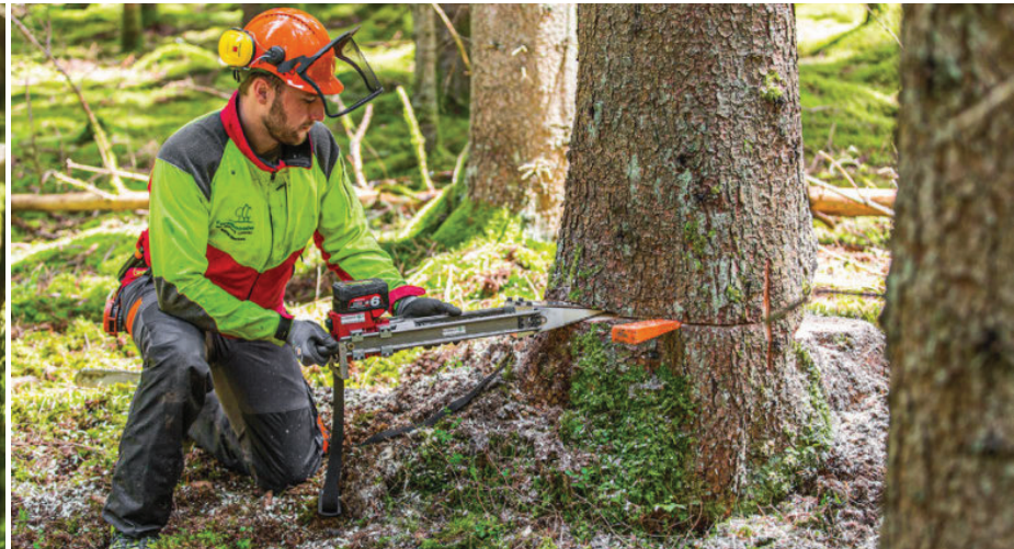
Raus aus dem Gefahrenbereich: Besonders wenn die Gefahr hoch ist, dass Äste abbrechen und herabstürzen, sind Funkkeile ein Segen – denn bedient werden sie per Knopfdruck aus sicherer Entfernung. Mit dem Seil lässt sich das Hebelgesetz nutzen: Doppelte Anschlaghöhe des Seils, bedeutet halber Zugkraftbedarf. Im Bild rechts ist das Seil in ca. 6 m Höhe. Darum sollte auch immer die nötige Ausrüstung am Start sein.
