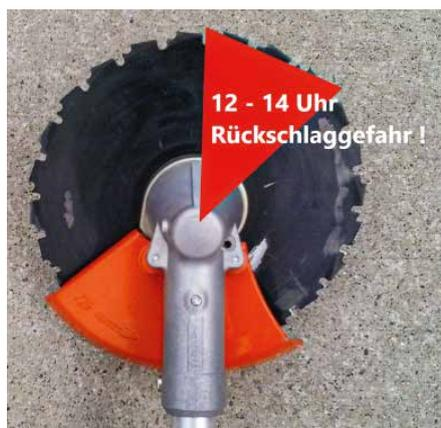
**Abb. 2:** Das Kreissägeblatt dreht nach links. Vorsicht: Nie mit dem rot markierten Segment (12 bis 14 Uhr) des Sägeblatts am Stamm ansetzen, es besteht Rückschlaggefahr!
