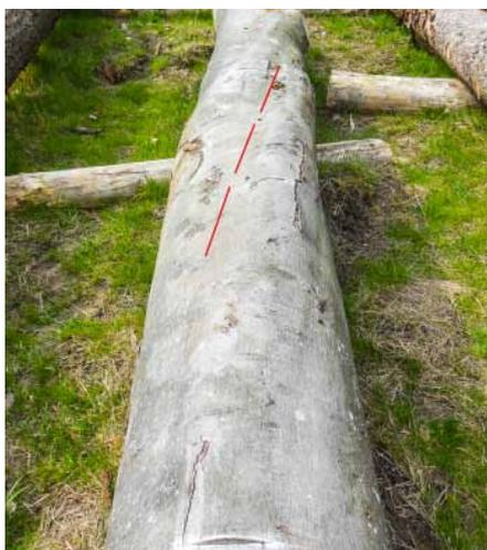
**Abb. 1a:** Die rote Linie folgt der Holzfaserrichtung und dokumentiert einen deutlichen Drehwuchs bei dieser Buche.
