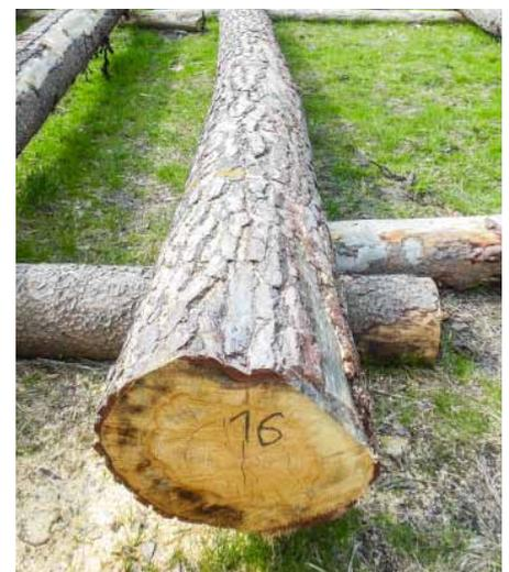
**Abb. 1c:** Diese Kiefer ist einschnürig gekrümmt. Bei Lichtbaumarten ist dies keine Seltenheit.
