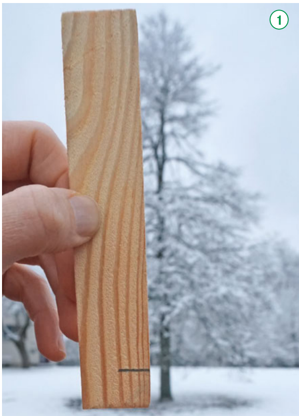
1 Markierung beim Zehntel der Länge: Die am Baum übertragene Höhe der Markierung entspricht einem Zehntel seiner Länge. 2 Höhenmessung mit dem Försterdreieck 3 Höhenmessung durch Winkelmessung.
