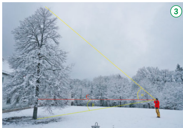
1 Markierung beim Zehntel der Länge: Die am Baum übertragene Höhe der Markierung entspricht einem Zehntel seiner Länge. 2 Höhenmessung mit dem Försterdreieck 3 Höhenmessung durch Winkelmessung.
