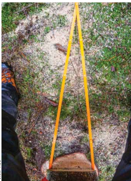
Abb. 3: Die Spitze des Meterstabs zeigt exakt in die Fällrichtung.
