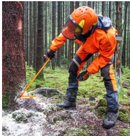
Abb. 2: Auch der korrekte Dachwinkel (45° bis 60°) lässt sich mit dem Meterstab überprüfen.
