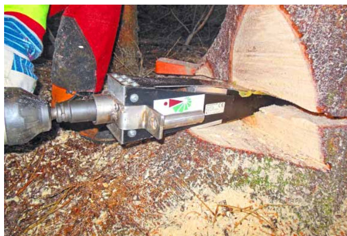
Abb. 4: Der Fällschnitt wird mittels eines Schnabelschnittes etwas aufgeweitet. Das sichtbare Schmierfett reduziert den Verschleiß der beweglichen Teile.
