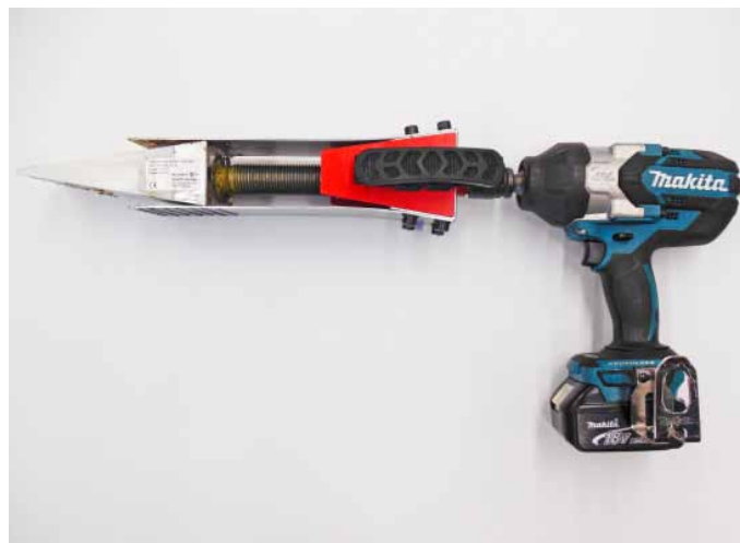
Abb. 2: Der zwischen den Edelstahl lamellen liegende Keil wird über die vom Schlagschrauber angetriebene Spindel nahezu erschütterungsfrei in den Fällschnitt geschoben.
