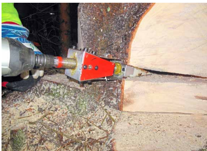
Abb. 3: Der Keil sollte soweit eingeschoben werden, dass die Noppen an der Lamellenspitze sich im Holz verhaken.
