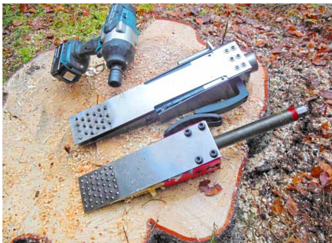
Abb. 1: Derzeit gibt es zwei mechanische Fällkeile mit Schlagschrauberantrieb, die das KWF-Profi-Prüfsiegel haben: der TR 30-AQ von Forstreich und der ValFast von BaSt-Ing.
