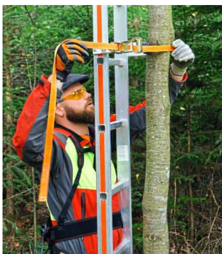
Abb. 4: Die Distelleiter muss mit einer Kurzsicherung mit Stahleinlage am Baum gesichert werden.
