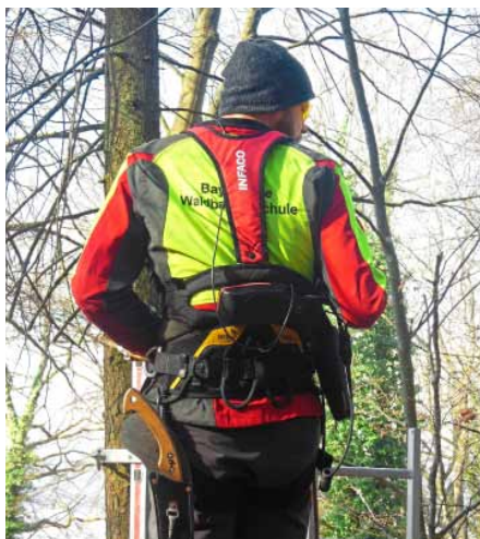
Abb. 2: Der etwa 1 kg schwere Akku lässt mithilfe eines Schultertragegurtes auf dem Rücken mitführen.
