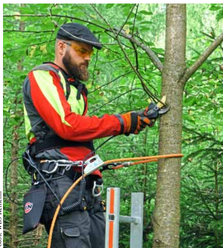
Abb. 1: Bei der Arbeit mit der Akkuschere F3015 hat sich die Kombination mit einer Distelleiter bewährt.
