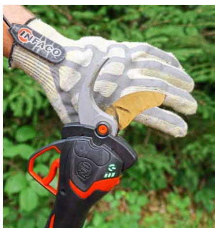
Abb. 3: Der Handschuh ist durch ein Kabel mit dem Akku verbunden. Nähert sich die Schere bis auf 5 mm dem Handschuh, wird sie blockiert.
