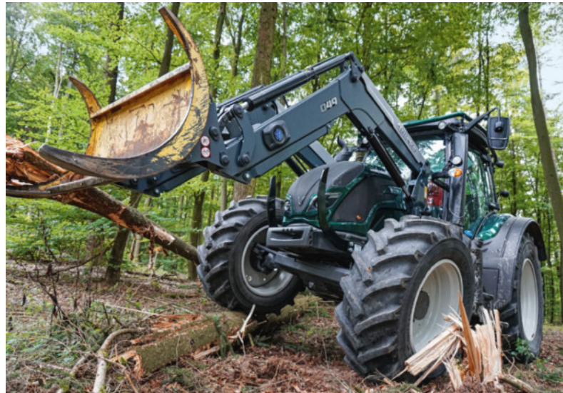
Äste, Wurzelstöcke und Kronenteile: Für den Einsatz im Wald sollten zumindest Tank, Leitungen und andere empfindliche Bauteile des Schleppers durch einen Unterfahrschutz geschützt werden.
