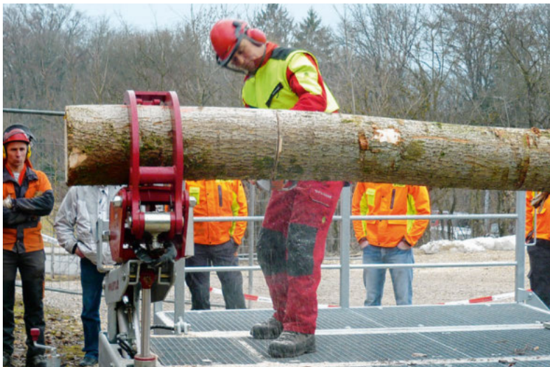
Die Schnittführung zählt: Am Spannungssimulator wird die Unfallgefahr bei der Holzaufarbeitung demonstriert.
