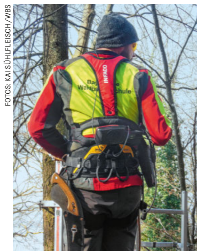
Huckepack: Der Akku wiegt rund 1 kg und kann mit dem Tragegurt auf dem Rücken getragen werden. Das erleichtert die Arbeit auf der Leiter und ermöglicht ein ergonomisches Arbeiten.
