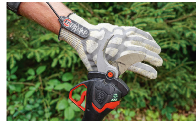
Elektronische Sicherheitseinrichtung: Der Handschuh ist über ein Kabel mit dem Akku verbunden. Nähert sich der Handschuh der Schere auf 5 mm, wird die Schere blockiert.
