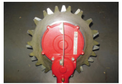
Schlaue Drehung: Gegenläufig rotierende Schneiden verhindern das Umherfliegen von Teilen.
