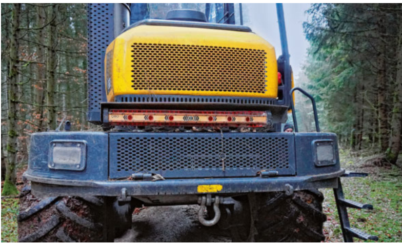
Version 1: Die etwa einen Meter lange Empfängerleiste, die den Laserstrahl erfasst, kann mit Magneten am Harvester befestigt werden.
