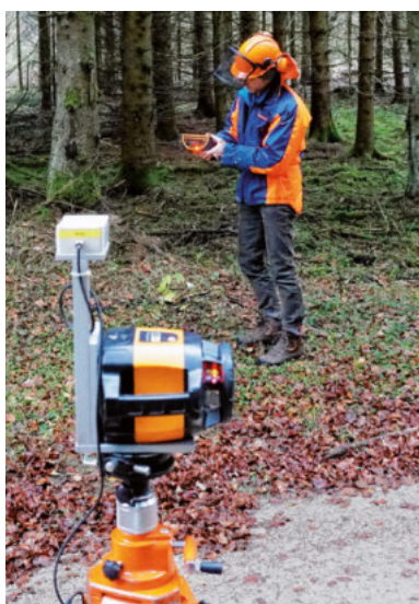
Version 2: Der Handempfänger wird am Mann geführt. Im Vordergrund ist der Richtlaser zu sehen.
