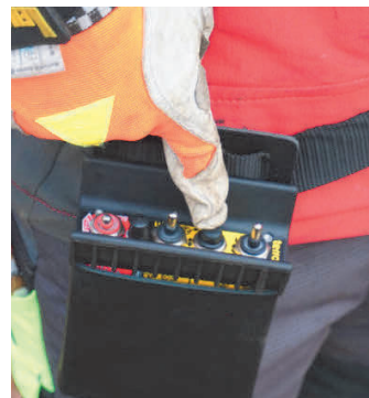
Sicherheit ertasten: Der Schalter „Ziehen“ sollte anders gestaltet sein als die übrigen.
