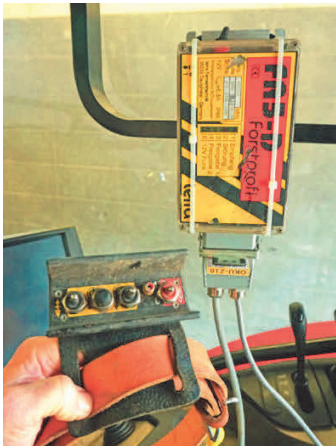
Reden miteinander: Sender- und Empfängereinheit einer Funkfernsteuerung.
