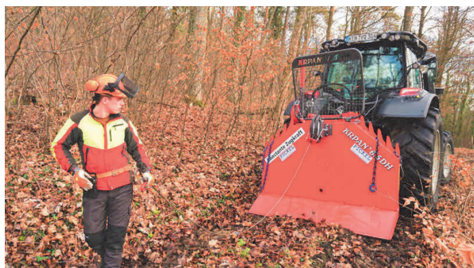
Sinnvolle Kombination: Die Funktionen Dauerlösen und Seilausstoß sind häufig miteinander gekoppelt.
