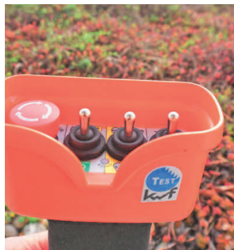
Schutzkragen: Er verhindert, dass Funktionen etwa durch Äste unerwünscht geschaltet werden.
